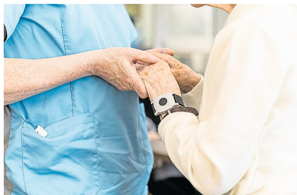
Wer nicht mehr alleine rausdarf, trägt eine Uhr. Diese sendet den Pflegerinnen und Pflegern eine Warnung, sollte die Trägerin oder der Träger die Demenzabteilung verlassen.
